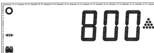
Colocar las piezas a contar (deben ser del mismo peso unitario que la muestra anterior) en la plataforma de pesada. Puede contarse dentro de un recipiente, previamente tarado (consultar apartado Uso de la Tara).
