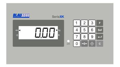
Tecla . Al pulsar esta tecla, con un recipiente u objeto sobre el indicador, pone a cero la lectura del display, dejando el indicador preparado para pesar el producto que introduzcamos en dicho recipiente, restando el peso del mismo. Se puede utilizar de forma continua, hasta completar la capacidad máxima del indicador. Al finalizar la operación, retirar el recipiente de el indicador y volver a pulsar la tecla .
